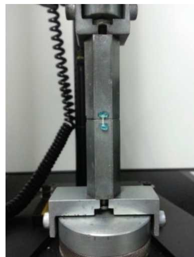
รูปที่ 2 ชิ้นทดสอบบนแท่นสำหรับทดสอบค่าความแข็งแรงยึดติดระดับจุลภาค
