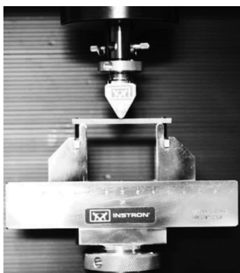
รูปที่ 4 การทดสอบคุณสมบัติคดขวางแบบ 3 จุด ด้วยเครื่องทดสอบสากลอินสตรอน
