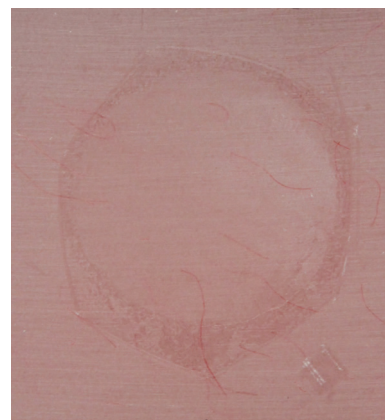
รูปที่ 4 ความล้มเหลวแบบยึดติดของชิ้นงาน Figure 4 Adhesive failure of specimen
