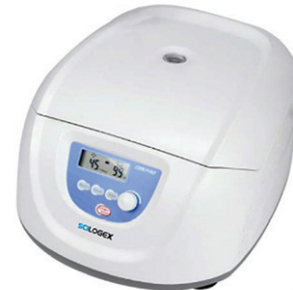
รูปที่ 1 เครื่องหมุนเหวี่ยงมีความเร็วที่ปรับได้ตั้งแต่ 300 ถึง 4500 รอบต่อนาที แรงเหวี่ยงสัมพัทธ์ (RCF) ตั้งแต่ 100 g ถึง 2,490 g เวลาทำงานตั้งแต่ 30 วินาที ถึง 99 นาทีและมีความจุหลอดขนาด 10 มล. จำนวน 12 หลอด.
