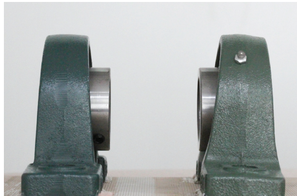
รูปที่ 1 ระบบยึดเครื่องมือทำขึ้นเฉพาะเพื่อใช้ยึดมาตรวัดแรงบิดดิจิทัลและกระดูกสังเคราะห์
